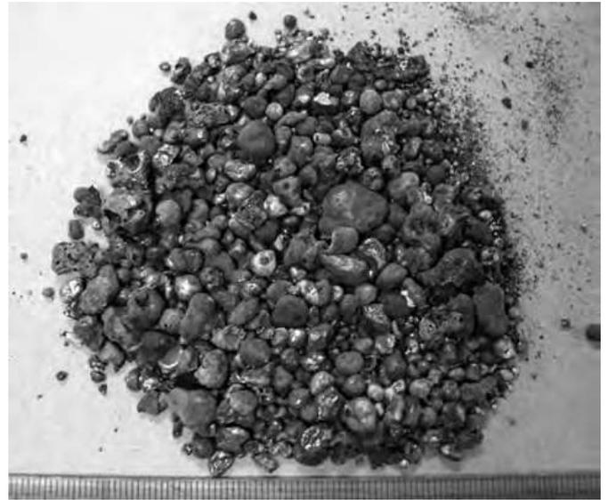
**(b)** Gewonnene Metallperlen nach dem Zerstoßen der Schlacke. Maßstab in mm (Rovira 2009, 410).
