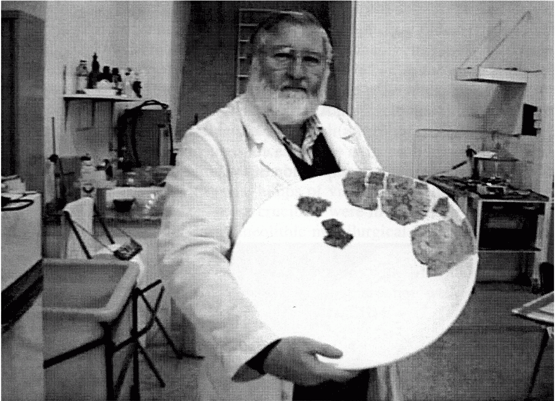
Tafel 4: Rekonstruktion eines offenen Schmelz- und Reduziertiegels aus La Ceñuela, Murcia, zur gleichzeitigen Röstung und Reduktion sulphidischer Kupfererze (Rovira 2002, 89).
